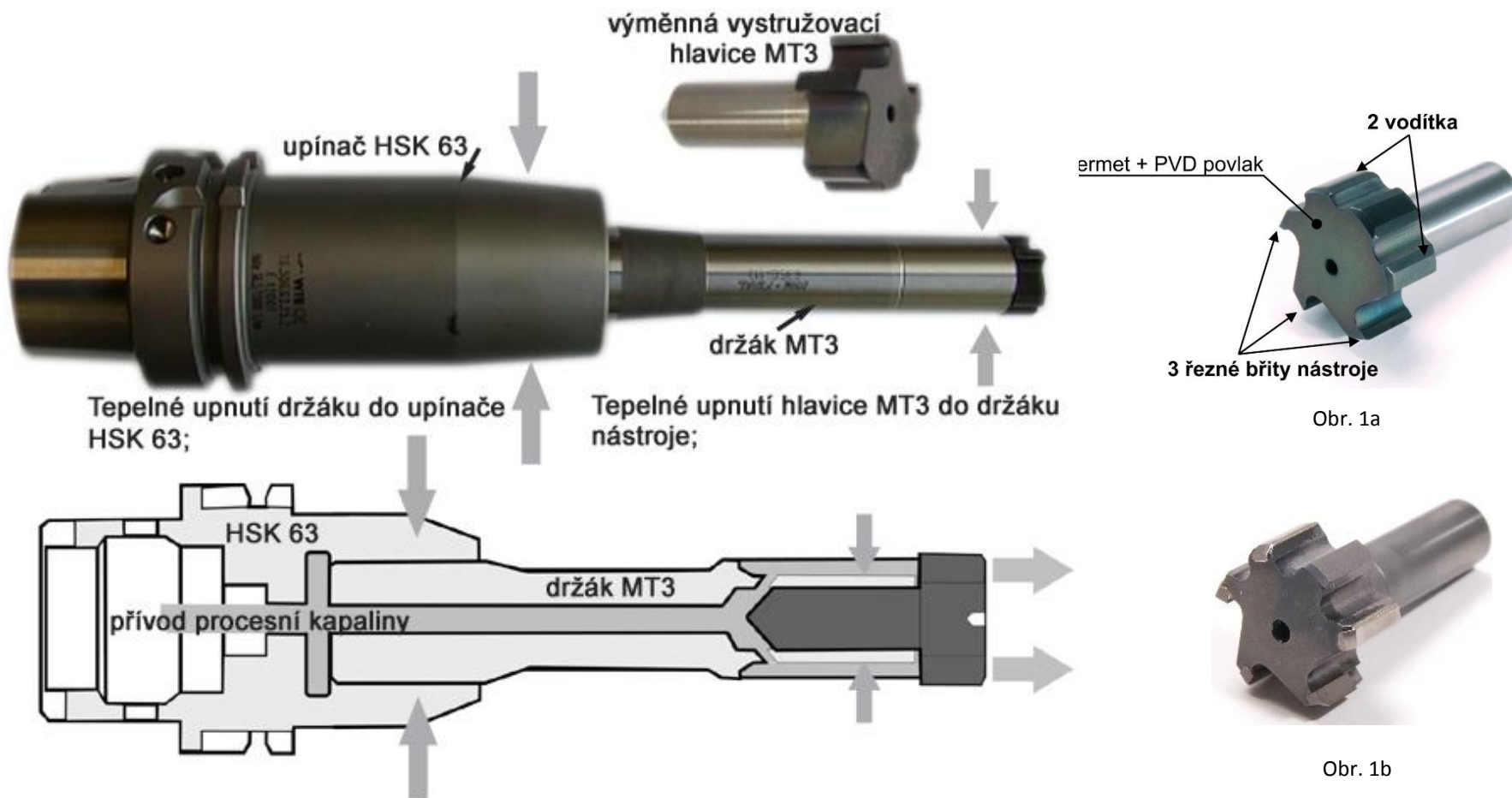
Obr. 2: Fotografie a schéma vystružovací hlavice upnuté v hydroupínači s naznačením míst tepelného upínání a přívodu procesní kapaliny.
